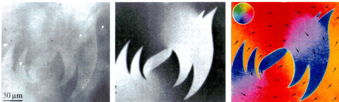
Abbildung 1 Abbildung magnetischer Domänen einer Fe-Ni-Oberfläche durch Kerr-Mikroskopie (aus A. Hubert & R. Schäfer, Magnetic Domains): Links: Magnetischer und Polarisationskontrast im Lichtmikroskop Mitte: Bildverbesserung durch Differenzbild-Technik Rechts: Quantitative Auswertung der Magnetisierungsrichtungen
